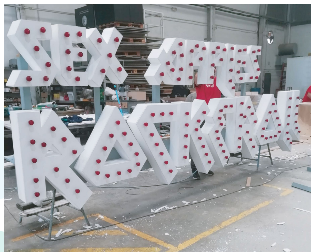
Proceso de montaje del rótulo iluminado.
